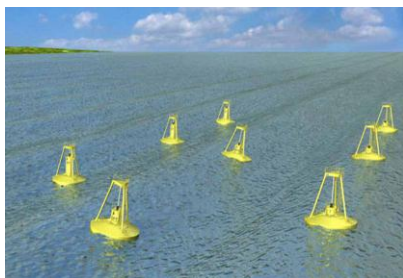
شکل ۴. دستگاه جذب نقطه‌ای انرژی موج
